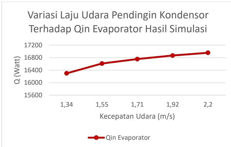
Gambar 4. 7 Grafik Variasi Laju Udara Pendingin Kondensor Terhadap  $q_{in}$  Evaporator Hasil Simulasi
