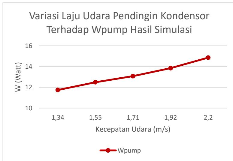
Gambar 4. 10 Grafik Variasi Laju Udara Pendingin Kondensor Terhadap Wpump Hasil Simulasi
