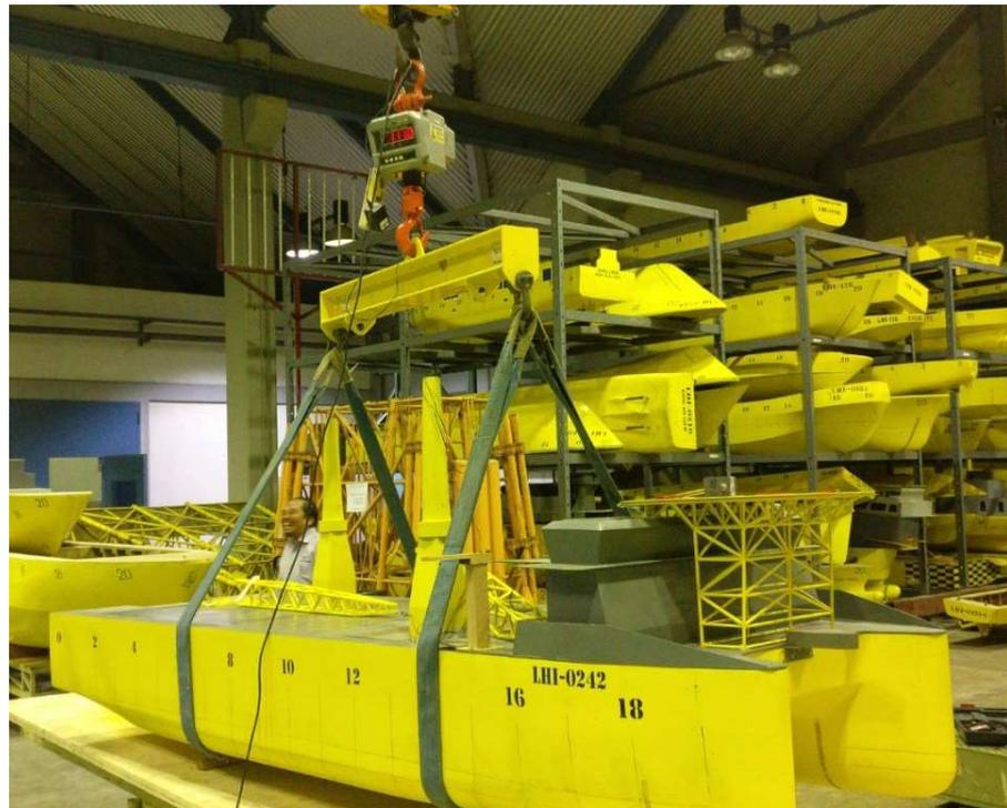
**Gambar 4.1** Proses Penimbangan Struktur Model Eksperimen
