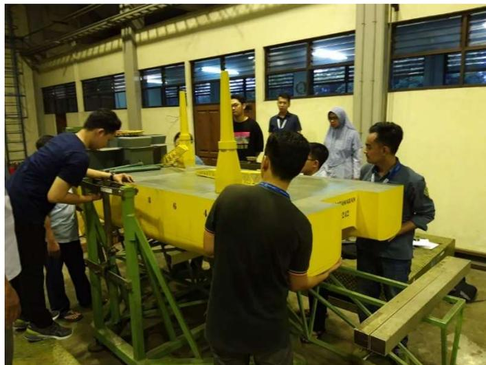
**Gambar 4.3** Kalibrasi Nilai LCG pada Model Struktur
