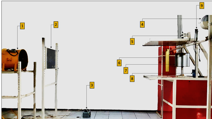
Gambar 3. 2 Instalasi axial fan dan honeycomb terhadap turbin angin Savonius
