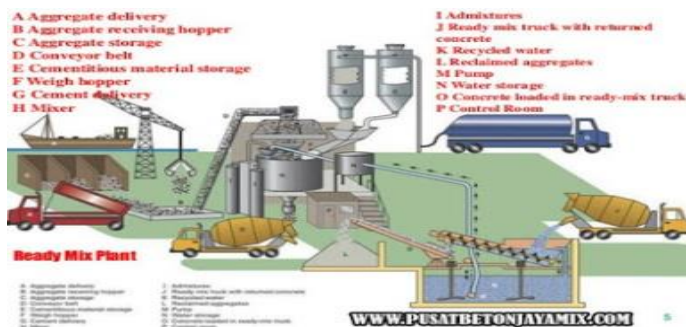
Gambar 2.7 Mekanisme produksi beton
