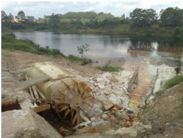
Gambar 2.7 Pengolahan Air Asam Tambang Secara Aktif
