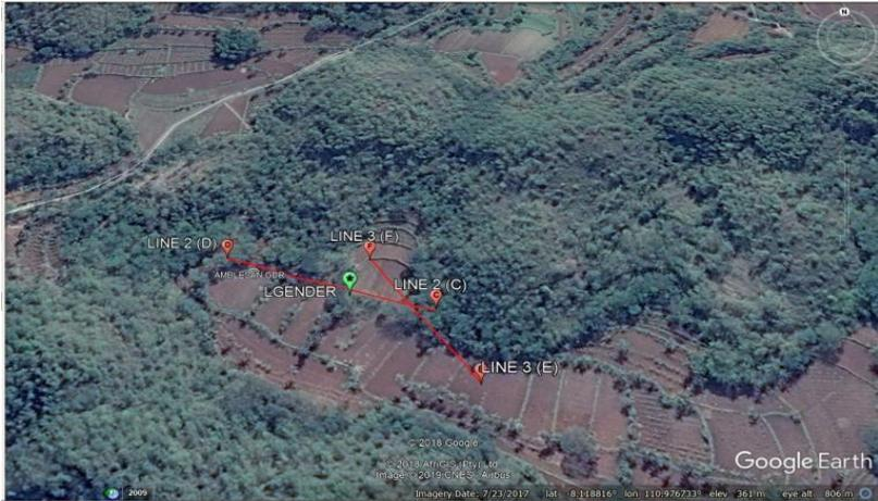
**Gambar 3.5** Desain Akuisisi lintasan 2 dan 3 pada lokasi 2. Marker hijau menunjukkan manifestasi luweng/goa, marker merah menunjukkan titik akhir dan awal lintasan geolistrik, dan line merah menunjukkan lintasan pengukuran geolistrik.
