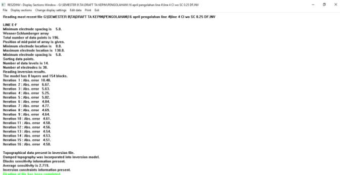
Gambar 30 hasil *running* dengan *damping factor* 0.25
