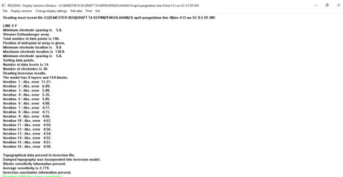
Gambar 31 hasil *running* dengan *damping factor* 0.5
