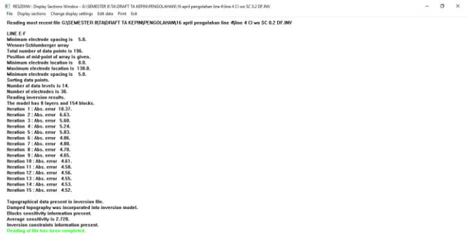
Gambar 29 hasil *running* dengan *damping factor* 0.2
