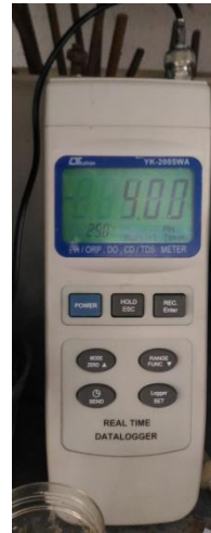
Lutron YK 2005 untuk analisis pH, DO, dan konduktifitas
