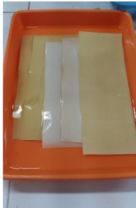
Perendaman membran AEM dan CEM menggunakan NaCl 5%
