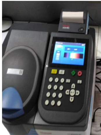
Spektrofotometri Geneys 30 untuk analisis amoniam, nitrit, nitrat dan fosfat
