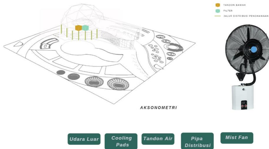
Gambar 4.14 Sistem Utilitas Penghawaan Dome
