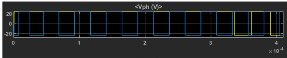
**Gambar 4.13.** Respon simulasi tegangan *open loop* 24V dengan beban
