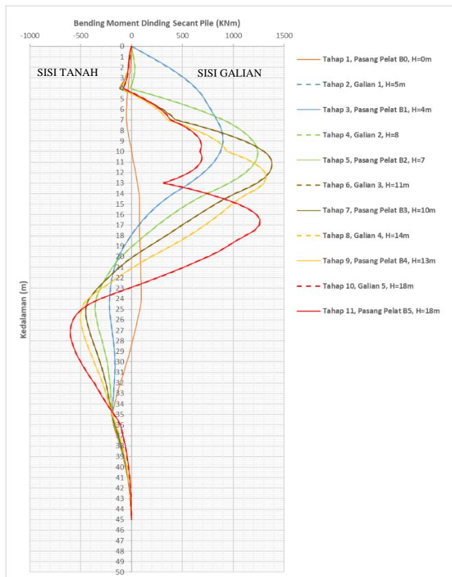
**Gambar 4. 29** Grafik Perbandingan *Moment* pada *Secant Pile* untuk Setiap Tahapan Penggalian
