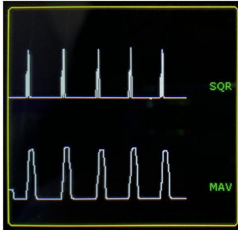
**Gambar 4.10:** Sinyal ECG yang telah di Moving Average Window
