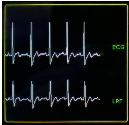
Gambar 4.6: Sinyal ECG yang telah di Low Pass Filter
