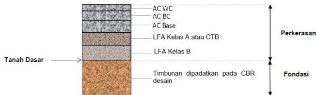
Gambar 2. 12 Perkerasan Lentur pada Timbunan
