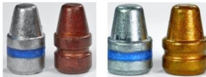
**Gambar 2. 5** Perbandingan proyektil yang diberi pelumas dan polimer (Miller, 2017)
