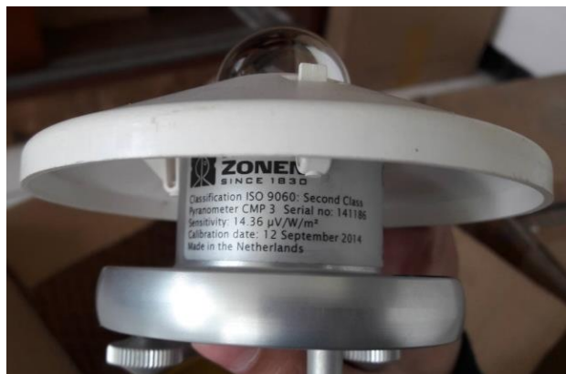
Gambar 3. 17 Label yang tertera pada piranometer menampilkan nilai sensitivitas alat
