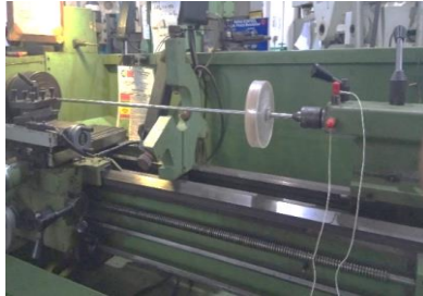
Gambar 2. 13 Mesin bubut dengan mekanisme RVD 4 pegas (Anggitasari, 2019)
