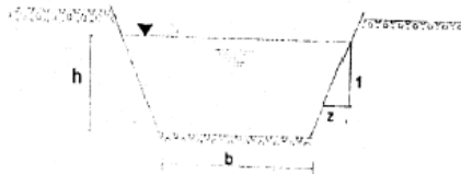
Gambar 2.13 Saluran Bentuk Trapesium (Sumber : Departemen Pekerjaan Umum, 2006)
