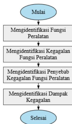
Gambar 3. 4. Alur Penyusunan RCM II *Information Worksheet*
