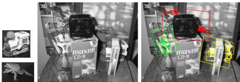
Gambar 2.9 Contoh hasil ekstraksi fitur menggunakan metode SIFT
