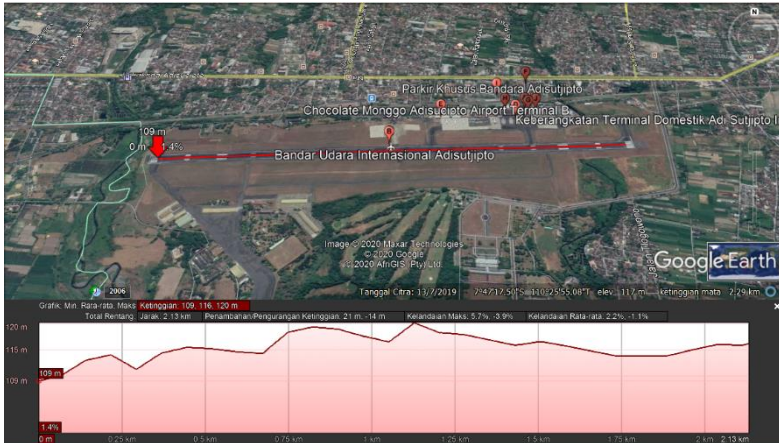
Gambar 4.4 Kemiringan Memanjang Runway Sumber : Google Earth
