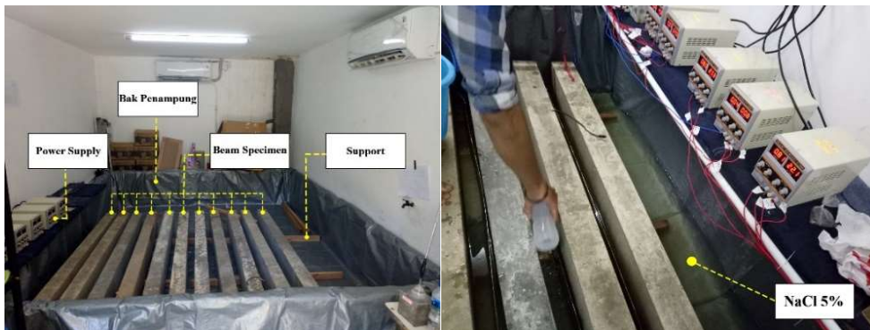
Gambar 3.7. Setup pengujian korosi galvanostatik.
