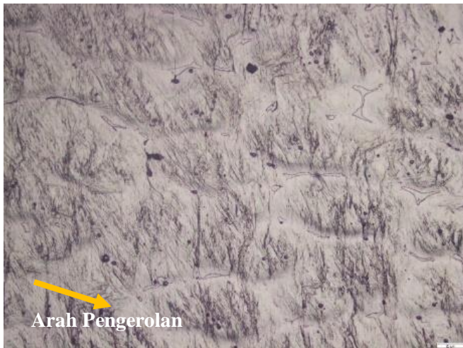
Gambar 3.11 Hasil Pengamatan Struktur Mikro Permukaan Atas Spesimen Cold Rolling Reduksi 52% Perbesaran (a) 50x (b) 100x (c) 200x
