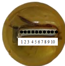
Gambar 4.10 Posisi Indentasi Pengujian Kekerasan pada Sisi Samping Spesimen Stainless Steel Thermal Cycling 900°C.
