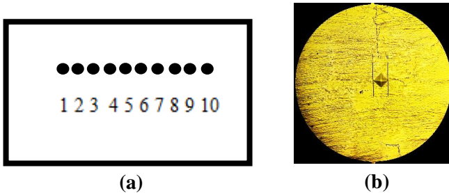
Gambar 3.17 (a) Posisi Indentasi Pengujian Kekerasan pada Permukaan Atas Spesimen Stainless Steel 316L Setelah Cold Rolling (b) Hasil Indentasi Pengujian Kekerasan Spesimen Stainless Steel 316L Setelah Cold Rolling
