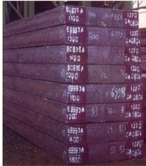
Gambar 4. 8 Hasil Akhir Produksi Pabrik Slab Steel Plant
