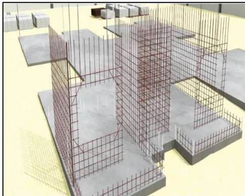
Gambar 4. 26 Pemasangan Besi Kolom Sumber: (Dokumen Pribadi, 2020)
