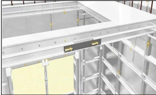
Gambar 4. 30 Bekisting Slab Sumber: (Dokumen Pribadi, 2020)
