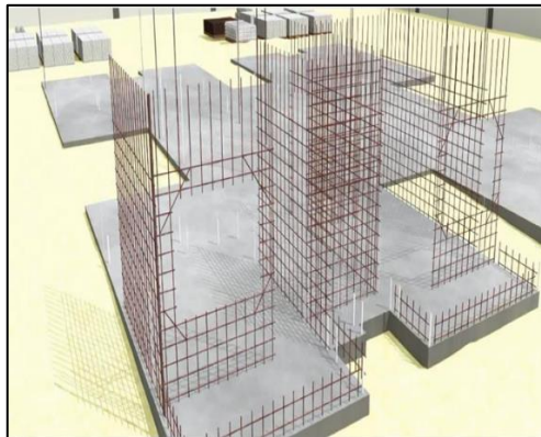
Gambar 4. 42 Pemasangan Besi Vertikal Sumber: (Dokumen Pribadi, 2020)
