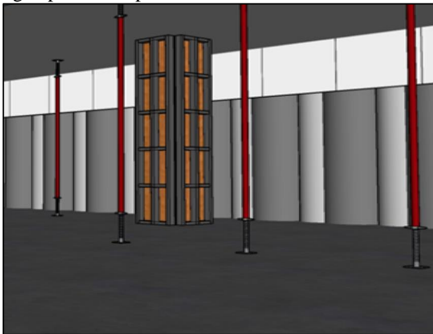
Gambar 4. 8 Bekisting Kolom Sumber: (Dokumen Pribadi, 2020)
