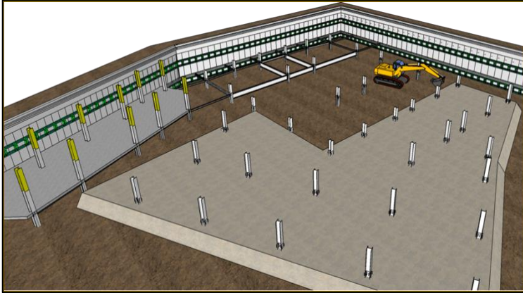
Gambar 2. 5 Pekerjaan Galian dan Pengecoran Pelat Lantai Basement
