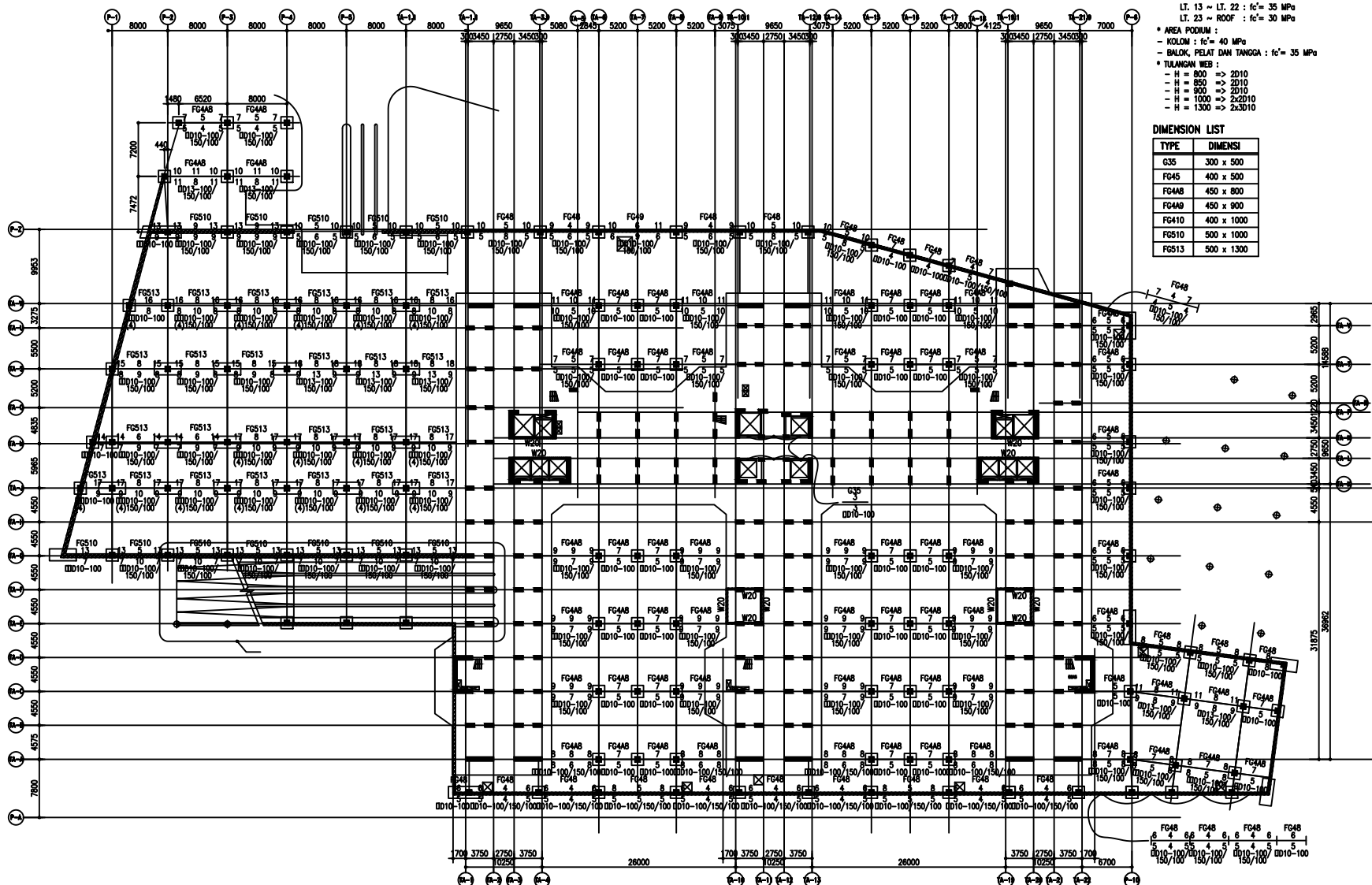
DENAH PEMBESIAN BALOK LT. BASEMENT 1 (ARAH-X)
