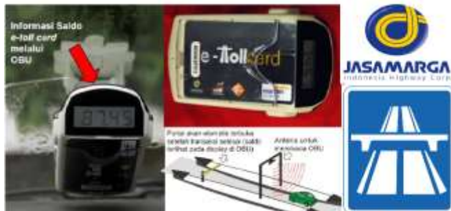
Gambar 2.8 Sistem Pembayaran Gardu Tol On Board Unit (OBU) (Sumber: https://ketagihanbayar.wordpress.com/2015/08/24/ingin-bayar-tol-lebih-mudah-dan-aman-gunakanlah-trik-berikut-ini/ )
