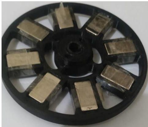
Gambar 4.3. Roda Tempat Magnet Generator BLDC
