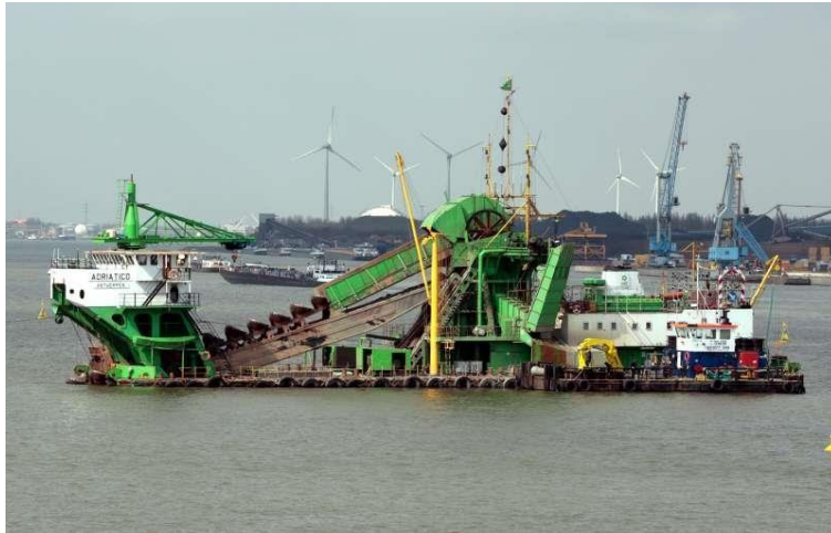
Gambar 2.9 Bucket Dredger (sumber: www.kapalku.com )
