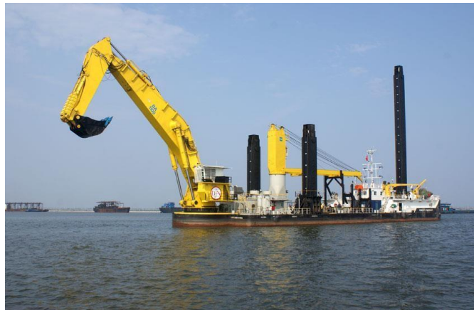
Gambar 2.10 Backhoe Dredger (sumber: www.kapalku.com )
