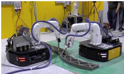
Gambar 1.3. Ilustrasi Konstruksi Bangunan Menggunakan 6-DOF Robotic Arm
