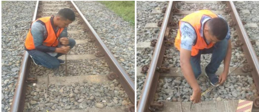
Gambar 4. 2 Pengukuran Tebal Balas
