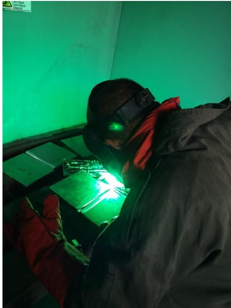
**Gambar 3.6.** Proses pengelasan plat aluminium
