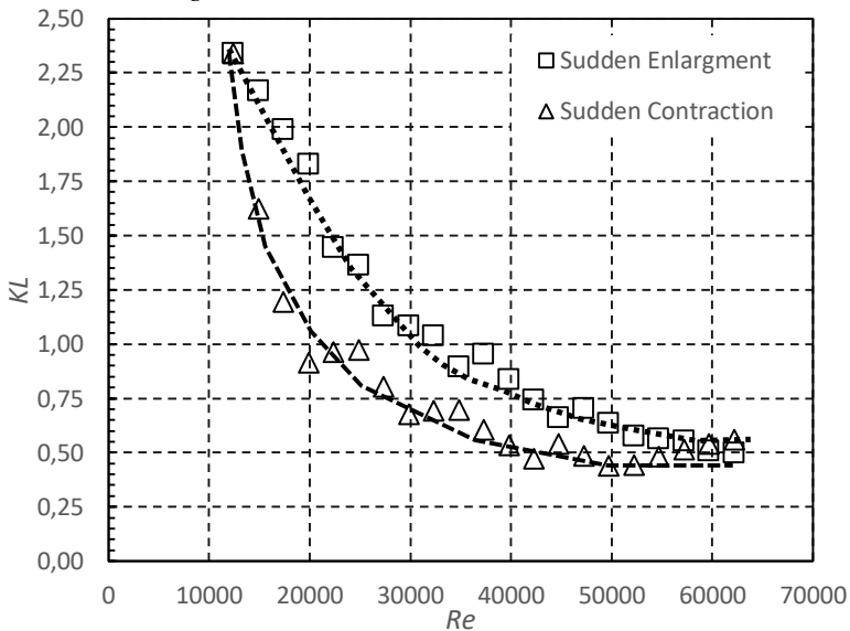
Gambar 4.5 Grafik hubungan loss coefficient ( K_L ) dan Reynolds number ( Re ) pada Sudden Contraction dan Sudden Enlargement
