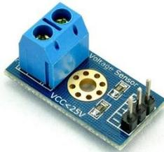
Gambar 2.7. Sensor Tegangan
