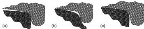
Gambar 2. 25 Situasi kontak yang memungkinkan antara roda dengan rel: (a) single-point contact ; (b) two-point contact ; (c) conformal contact .
