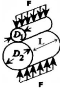
Gambar 2. 15 Kontak rel-roda yang mirip dengan kontak antara dua silinder berdasarkan teori Hertz
