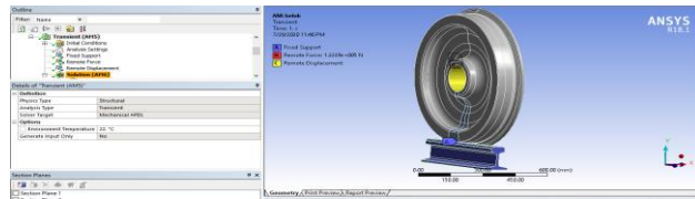
Gambar 3. 42 Pembebanan pada roda bagian luar kereta ketika berbelok
