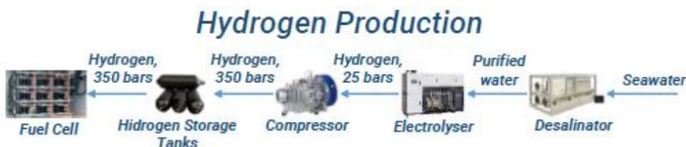
Gambar 5.9 Proses Produksi Gas Hidrogen *On-Board*
