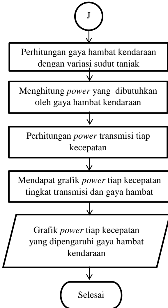
Gambar 3. 14 Flowchart perhitungan karakteristik power kendaraan Toyota Calya listrik
