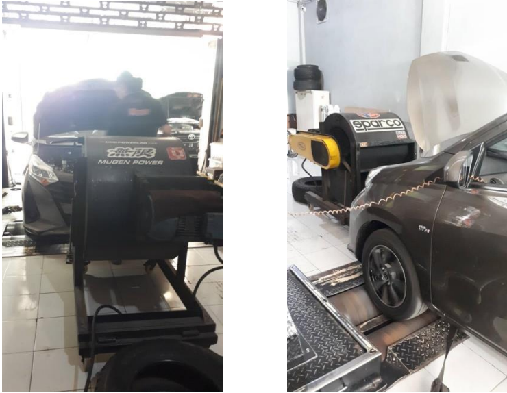
Gambar 3. 5 Pengambilan data dengan pengujian dynotest
