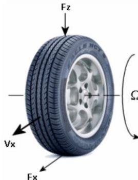
Gambar 3.21 Gaya – gaya yang bekerja pada roda kendaraan
