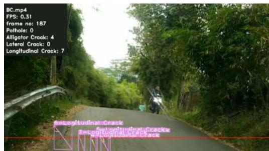
Gambar 5.8: Contoh Permasalahan Saat Melakukan Pengenalan Kerusakan *Alligator Crack*
