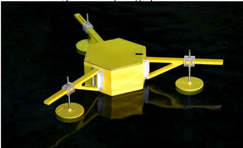
*Gambar 3.2 Bentuk prototype ponton*
