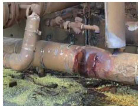
Gambar 1.9 Efek korosi di area process plant akibat proses operasi.
