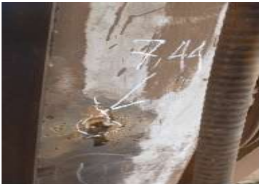
Gambar 1.9 Efek korosi di area process plant akibat proses operasi.
