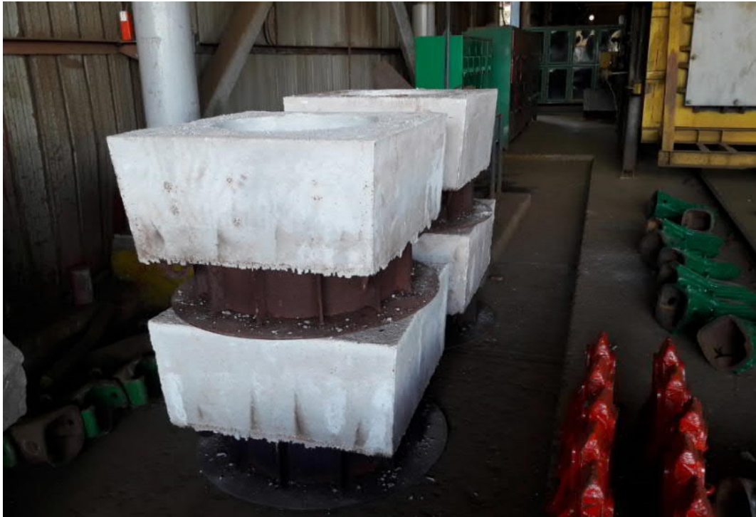
Gambar 14.7. Unit Tahu Murray Furnace Setelah di Lakukan Proses Pembakaran di Dalam Burner .
