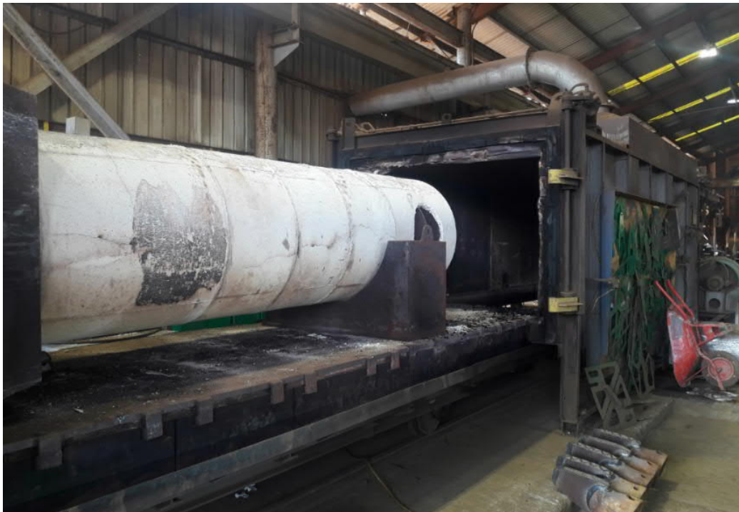
Gambar 12.5. Penempatan Unit Air Pipe Kiln ke Dalam Burner Menuju Proses Pembakaran.
