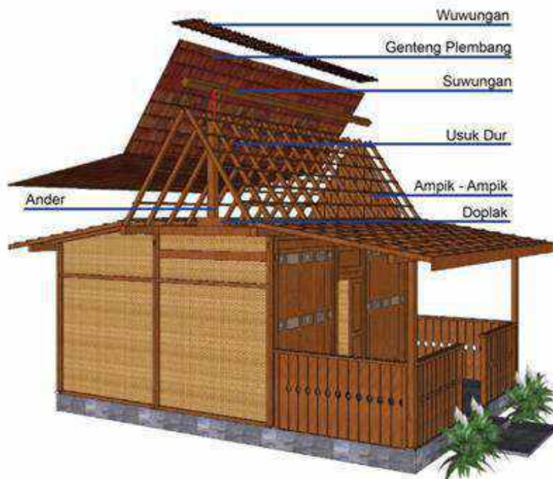
Gambar 2.6 Struktur Atap Bangunan Berarsitektur Osing
