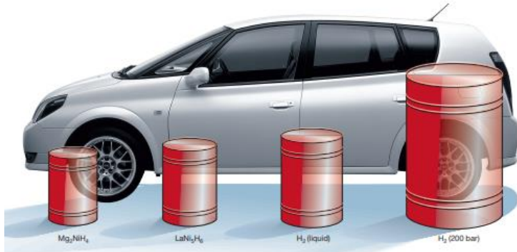
Gambar 2.2 Perbandingan kontainer hidrogen dari segi ukuran fisik
