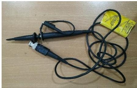
**Gambar 3. 16 *Probe Tegangan***
