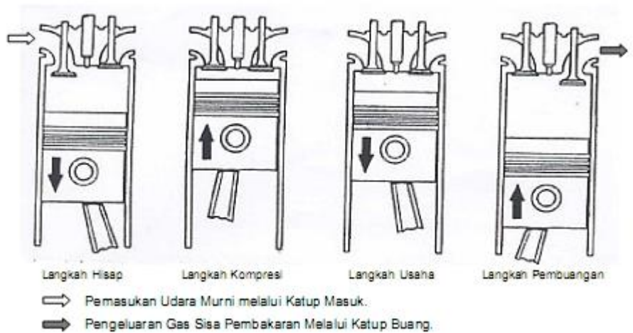
Gambar 2 2 Langkah Kerja Mesin Diesel 4 Langkah
