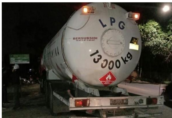
Gambar 4.9 Skid Tank dengan Kapasitas 13 Ton
