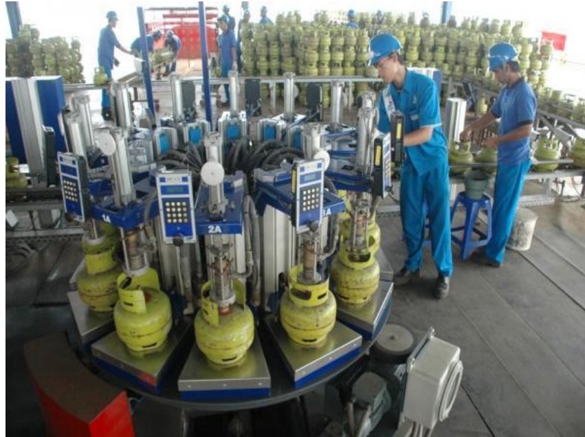
Gambar 2.5 Pengisian LPG ke Tabung di SPPBE
