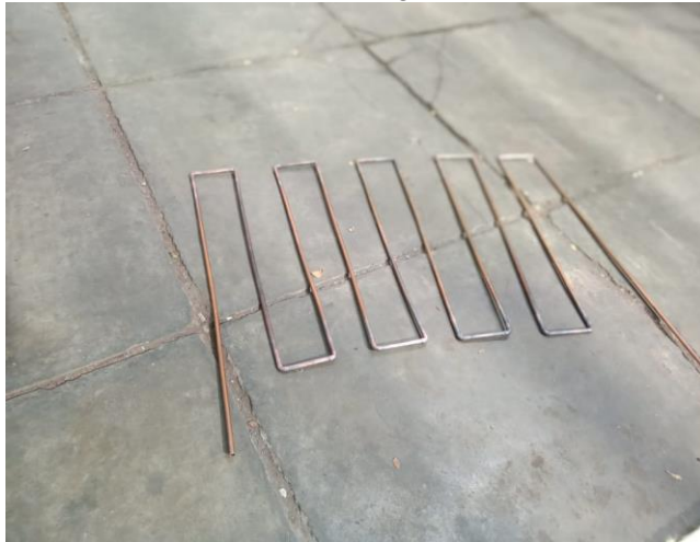
Gambar 3 6 Pipa Tembaga yang Telah Selesai Disambung Sumber : (dokumentasi pribadi)
