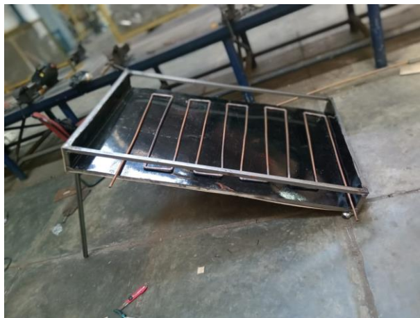
Gambar 3 9 Solar Collector yang Telah Selesai Dirakit Sumber : (dokumentasi pribadi)
