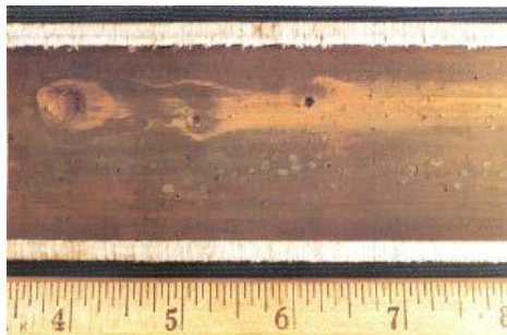
Gambar 2. 6 Oxygen Pit pada Bagian Superheater Tube. (Port, Herro and Robert, 1991)
