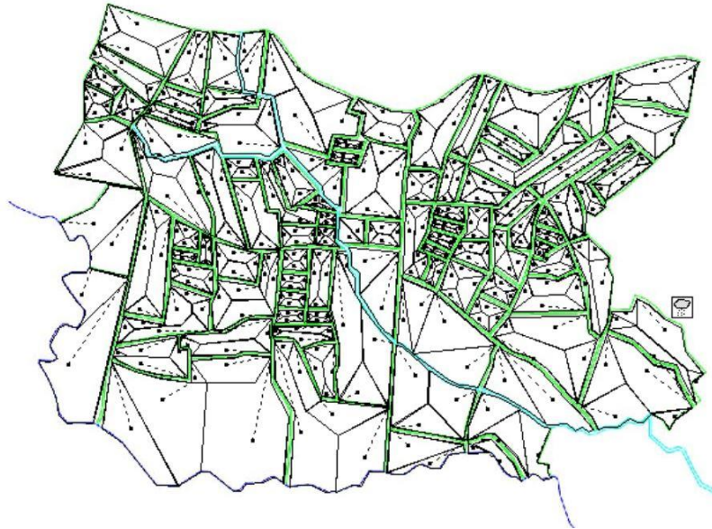
Gambar 4. 2 Cacthment Area pada Kelurahan Telihan Bontang Sumber: Hasil Perhitungan dan pengaplikasian SWMM
