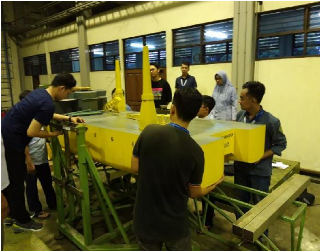
Gambar 4.2 : Proses peletakan model dan kalibrasi KG
