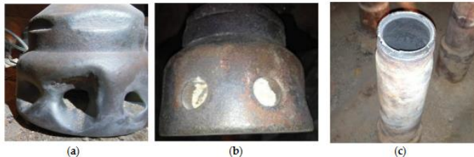
Gambar 2. 1 Kegagalan pada aircap
