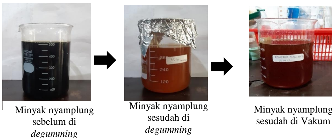
Gambar 4.2 Perbedaan hasil minyak nyamplung sebelum hingga sesudah dilakukan proses degumming .
